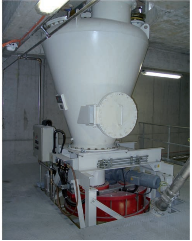
5. في هذا التركيب ، يستخدم نظام التغذية الدوار Pfister® TRW-S لتغذية أنواع الوقود البديل الزغبية والمغبرة بمعدل تغذية قدره 8 أطنان في الساعة ، وتم تركيب قادوس مجانسة فوق جهاز التغذية الدوار الأحمر
